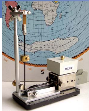
Bild 4: Pendel-Bug mit Schwingungsfreigabe. Die Verlängerung des Punkthebels drückt die Pendelstange mit dem Pendelgewicht gegen die Filzscheibe des Dämpfers
