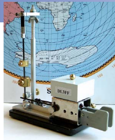
Bild 5: Mit einem Zusatzgewicht, das man seitlich auf die Pendelstange anbringt, kann bei Bedarf der Geschwindigkeitsbereich zum langsameren Tempo einfach und schnell verändert werden
